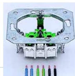
Парные пружинные зажимы располагаются с одной стороны, что ускоряет подключение. А перед установкой лицевых панелей достаточно одного взгляда, чтобы убедиться в правильности подключения всех проводов. Кстати, отсоединение проводов производится также просто, как и подключение. Для этого достаточно нажать на пластиковые разжимающие рычажки пружинных клемм и извлечь провод.
