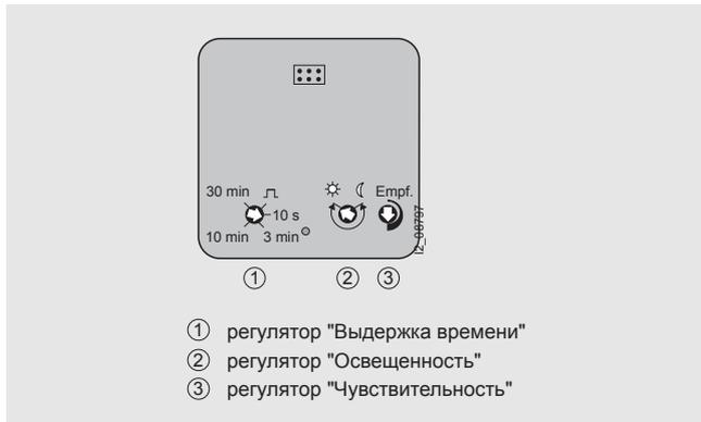
В качестве специального режима работы детектор датчика движения "Комфорт" может быть также установлен в кратковременный режим. Кратковременный режим работает независимо от освещенности и может использоваться, например, для управления звонком.
