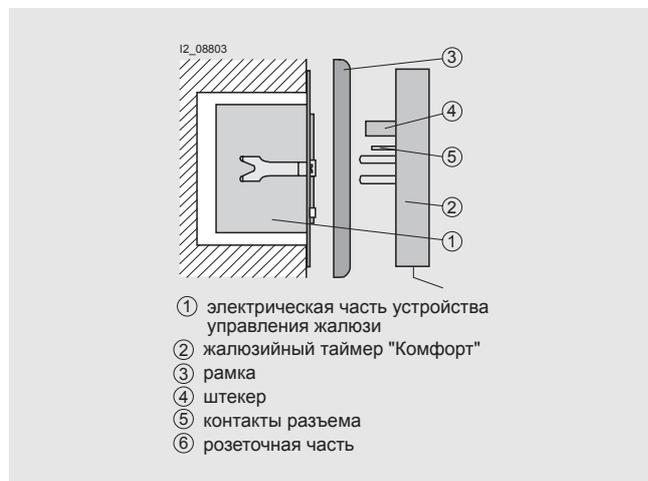
Электрическая часть устройства управления жалюзи (1) устанавливается в монтажной коробке согласно DIN 49073 (Рекомендуется использовать глубокую монтажную коробку).
